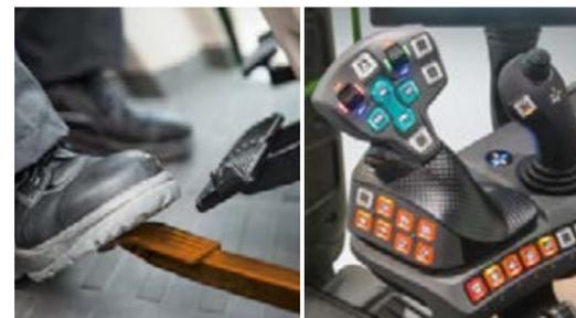
Inversion du sens de la marche sans usure avec fonctions Neutre et Stop and Go intégrées. Transfert de puissance constante pour une accélération tout en souplesse, respectueuse des sols.
