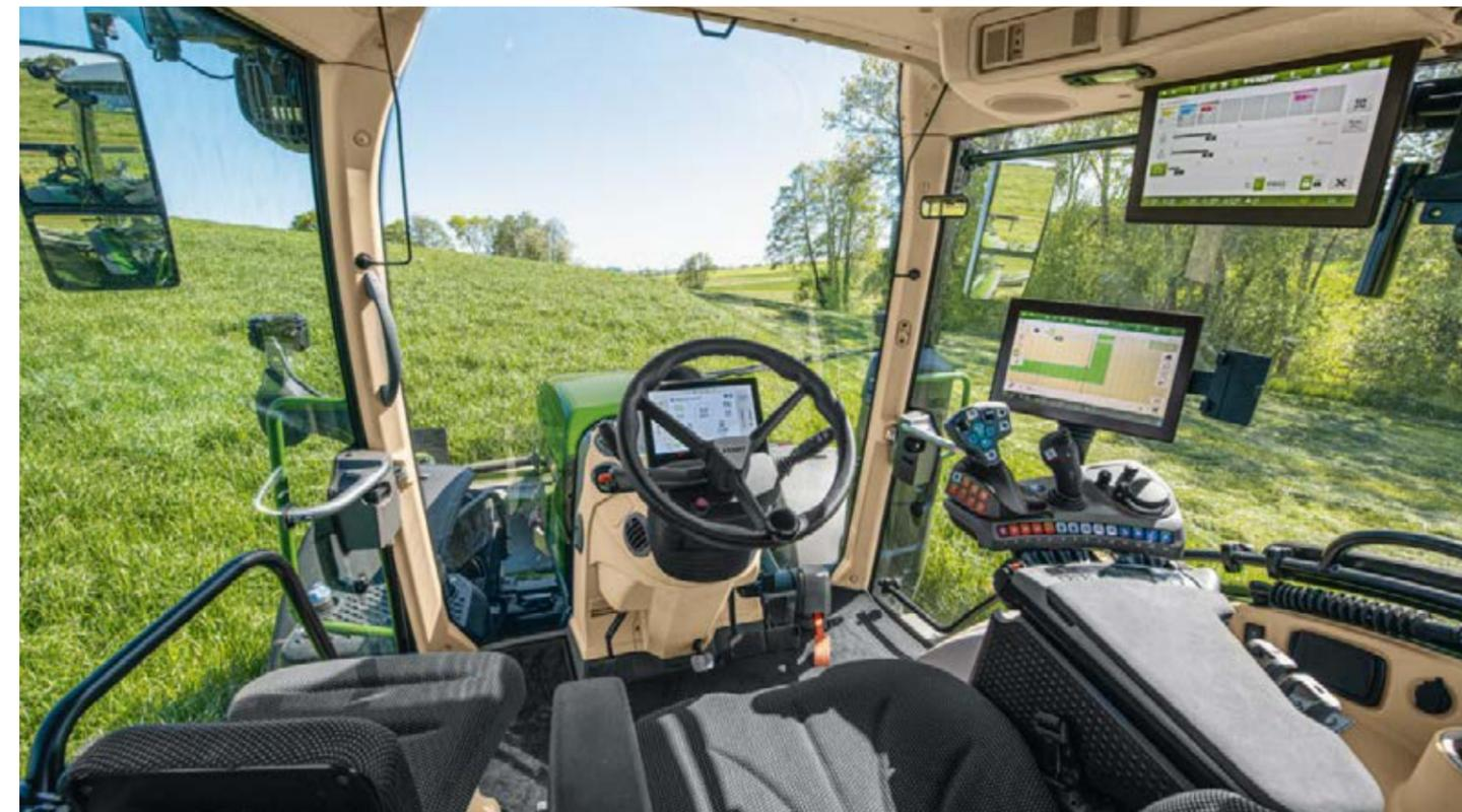
Fendt propose une solution intelligente pour les câbles en provenance de l'arrière du tracteur qui pénètrent dans la cabine. Les câbles peuvent être acheminés par le passe-câbles, quel que soit leur diamètre. Le conducteur peut fermer la vitre arrière pour empêcher la poussière, les impuretés, l'eau et le bruit de pénétrer à l'intérieur.
