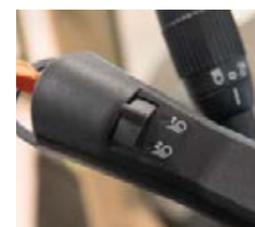
■ Deux modes d'éclairage programmables : utilisez l'interrupteur sur le levier d'inversion pour basculer rapidement entre les deux modes d'éclairage enregistrés, y compris le mode Route et le mode Champ.
