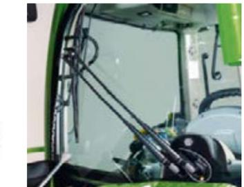
Deux essuie-glaces de pare-brise au choix : Essuie-glace rotatif à fonctionnement intermittent ou essuie-glace à balayage vertical pour un rayon d'action encore plus grand.
