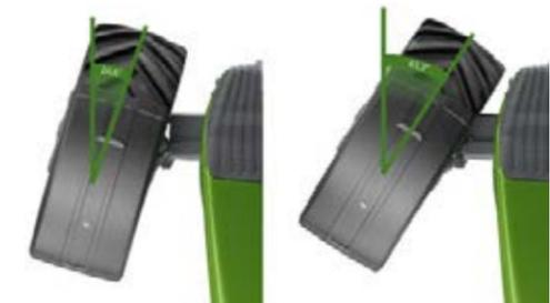
Que vous soyez en bout de champ ou que vous sollicitiez le chargeur frontal, vous bénéficiez déjà de la direction VarioActive\* en accomplissant un angle de braquage complet avec un seul tour de volant. Jusqu'à 8 km/h, il suffit d'un seul tour de volant pour pouvoir braquer à fond. Entre 8 et 18 km/h, l'effet de la direction à amplification variable diminue progressivement.
