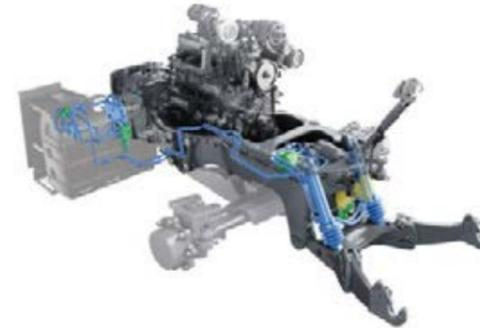
Le relevage avant est parfaitement intégré au demi-châssis, flasqué au tracteur. Cela permet aux machines attelées d'être extrêmement maniables. Les bras inférieurs se distinguent par une grande course et se replient facilement pour le transport. Des soufflets protègent les vérins de relevage des projections. L'amortisseur par boule d'azote installé de série évite les à-coups et offre une sécurité ainsi qu'un confort de conduite exceptionnels.
