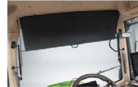
La poignée verticale de la lunette arrière est une spécificité du Fendt 300 Vario qui permet d'ouvrir et fermer simplement la fenêtre, tout en restant assis.
