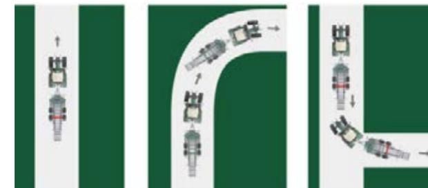
Blocage automatique de l'essieu suiveur : ce système d'assistance débloque l'essieu suiveur à une vitesse prédéfinie. En ligne droite, l'essieu suiveur bloqué assure la stabilité. L'utilisateur n'a pas besoin de verrouiller l'essieu suiveur manuellement en dehors de la plage de vitesses présélectionnée ni lorsqu'il passe en marche arrière.
