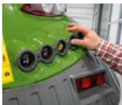
Le relevage arrière, la prise de force et l'un des distributeurs peuvent être commandés depuis les deux ailes arrière du tracteur.
