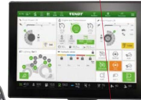
Utilisez le bouton-poussoir central pour décider ce que vous souhaitez afficher sur le Fendt 300 Vario. Vous disposez également de quatre touches d'accès rapide pour les fonctions Retour, Launchpad, Aperçu, Individual Operation Manager (IOM) et basculement entre le terminal et le tableau de bord.
