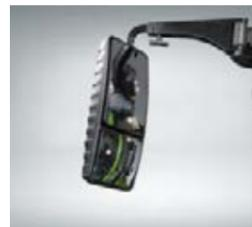
■ Le rétroviseur grand angle est intégré dans la partie basse du rétroviseur, de manière à offrir une visibilité excellente pour manœuvrer et vérifier les angles morts. La deuxième variante est un rétroviseur dégivrant électrique (Profi/Profi+).
