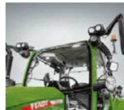
□ Version avec pre-brise panoramique ouvrant et porte à droite. Comprend une deuxième poignée pour fermer la fenêtre. De cette manière, la fenêtre offre une sécurité totale. Fermée, elle est parfaitement étanche et ne laisse pas passer le bruit.
